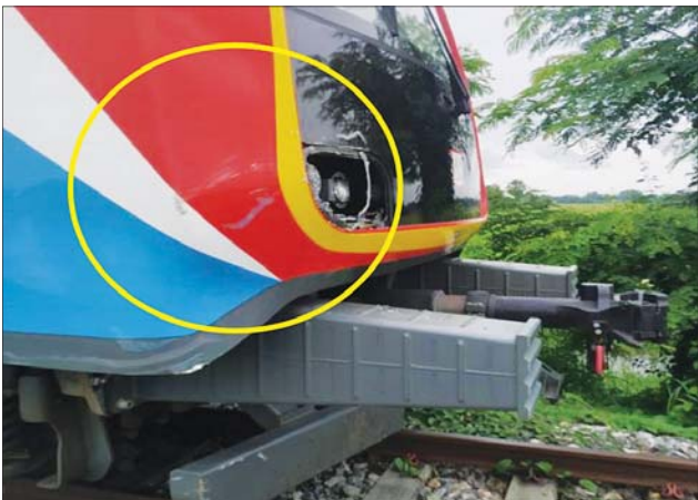
သောင်းတိုင်ကုန်းနှင့် တောင်ငူဘူတာအကြား အမှတ်(၇)အဆန် DEMU ရထားနှင့် ဘေးတွဲဆိုင်ကယ် ပွတ်တိုက်မှုကြောင့် ရထားရှေ့ စက်ခေါင်းမီးလုံးကွဲအက်ခြင်း၊ ဆေးပွန်းခြင်း ဖြစ်ပွားခဲ့ပုံ။
