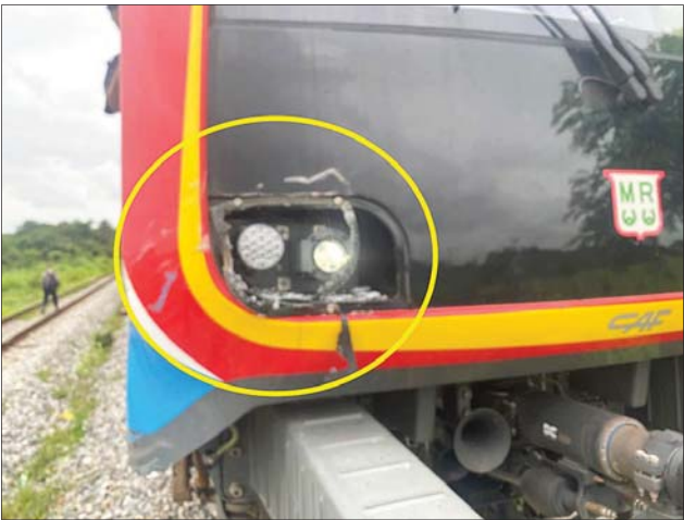
သောင်းတိုင်ကုန်းနှင့် တောင်ငူဘူတာအကြား အမှတ်(၇)အဆန် DEMU ရထားနှင့် ဘေးတွဲဆိုင်ကယ် ပွတ်တိုက်မှုကြောင့် ရထားရှေ့ စက်ခေါင်းမီးလုံးကွဲအက်ခြင်း၊ ဆေးပွန်းခြင်း ဖြစ်ပွားခဲ့ပုံ။
